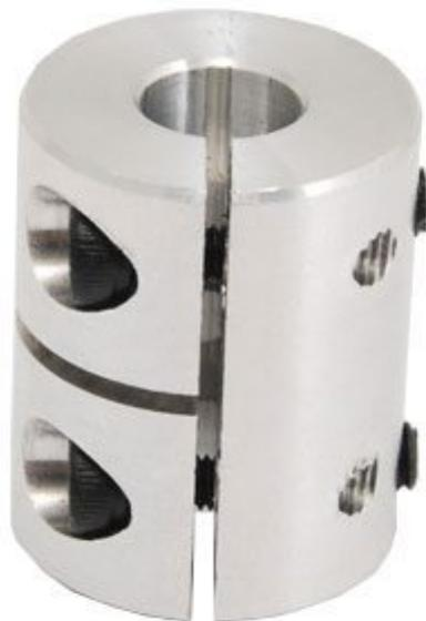
Realizzato in alluminio, questo giunto permette di accoppiare una barra filettata M8 con l'albero (diametro 5 mm) di un motore passo-passo Nema 17. Diametro esterno 20 mm, altezza 25 mm.
