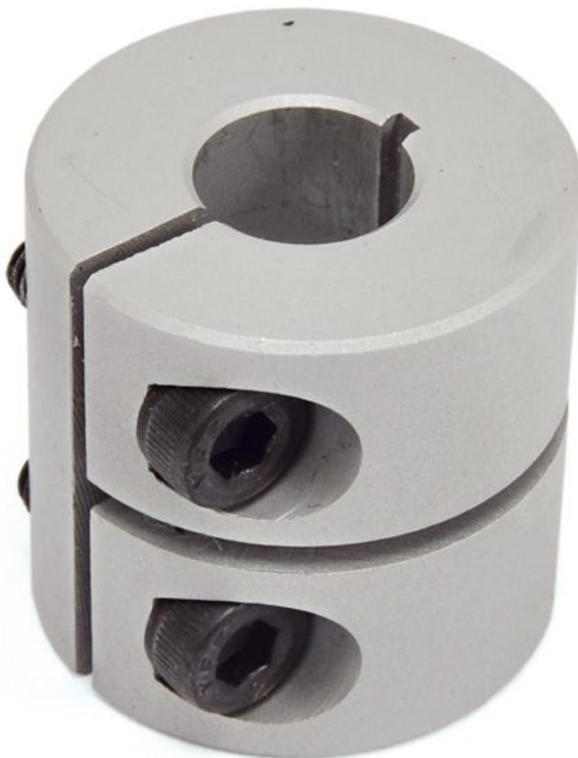
Realizzato in alluminio, questo giunto permette di accoppiare una barra filettata M8 con l'albero (diametro 5 mm) di un motore passo-passo Nema 17. Diametro esterno 20 mm, altezza 20 mm.
