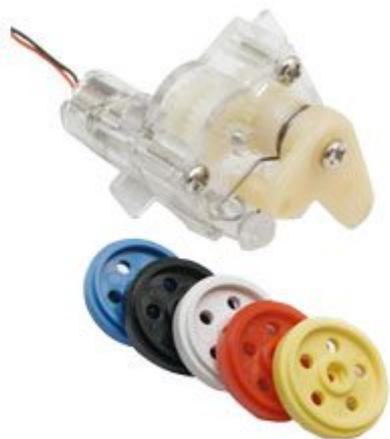
Set composto da un motoriduttore dalle dimensioni estremamente compatte (25,4 x 14,3 x 28,8 mm) e da una ruota. Il rapporto di riduzione è di 81:1 con una velocità di rotazione di 370 rpm, l'alimentazione è di 5 V con un consumo di 24,6 mA (184 mA in stallo), rotazione 60° (con possibilità di rotazione continua), peso: 5 g.
