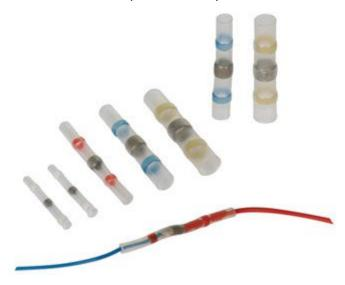
Guaina termorestringente con all'interno un anello di stagno e due anelli di adesivo. Permette di effettuare il collegamento elettrico (saldatura) di due conduttori mediante trattamento termico (tramite riscaldatore industriale), fornendo la tenuta dei due conduttori e rendendo impermeabile la saldatura. La confezione comprende 4 pezzi lunghi di 26 mm.
