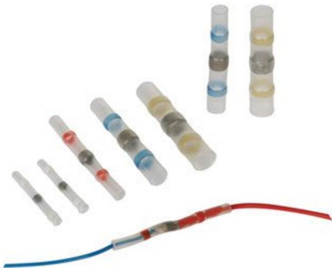
Guaina termorestringente con all'interno un anello di stagno e due anelli di adesivo. Permette di effettuare il collegamento elettrico (saldatura) di due conduttori mediante trattamento termico (tramite riscaldatore industriale), fornendo la tenuta dei due conduttori e rendendo impermeabile la saldatura. La confezione comprende 4 pezzi lunghi di 40 mm.
