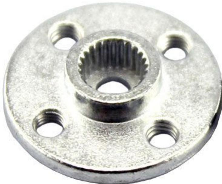
Mozzo universale in alluminio progettato per essere impiegato con il servo213 (MMG995) e con i servi RC standard Hitec, Parallax, Futaba, Fraser, ecc. Dispone di quattro fori filettati M3 e 25 denti.
