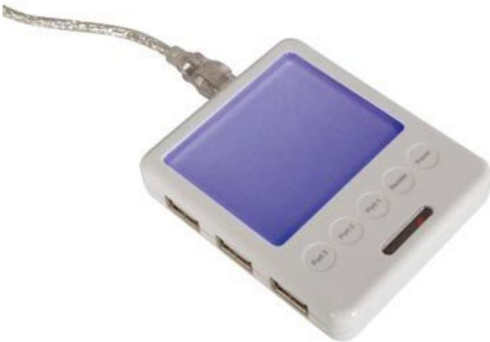
Elegante periferica comprendente un HUB USB a 3 porte con protocollo 2.0 ed un lettore scrittore in grado di funzionare con 21 tipi differenti di Card. Massima velocità di trasferimento 480 Mbps, compatibile con USB 1.1 (max. 12 Mbps). Completo di 5 led di segnalazione e superficie illuminata con luce blu a catodo freddo. Alimentazione dalla porta USB o con alimentatore esterno (non compreso).
