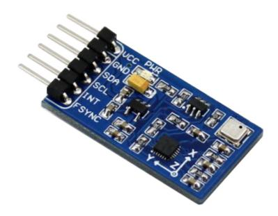
Piccola scheda basata sul chip MPU9255 (integra un giroscopio a 3 assi, un accelerometro a 3 assi e una bussola/magnetometro a 3 assi) e sul sensore di pressione barometrica BMP180. Comunicazione tramite interfacia I<sup>2</sup>C, alimentazione: 3,3V e 5,5V (con regolatore di tensione a basso dropout). Applicazioni: Quadricotteri, Bilanciamento robot, navigazione inerziale Indoor, altimetro barometrico, ecc. La scheda viene fornita completamente assemblata e testata.
