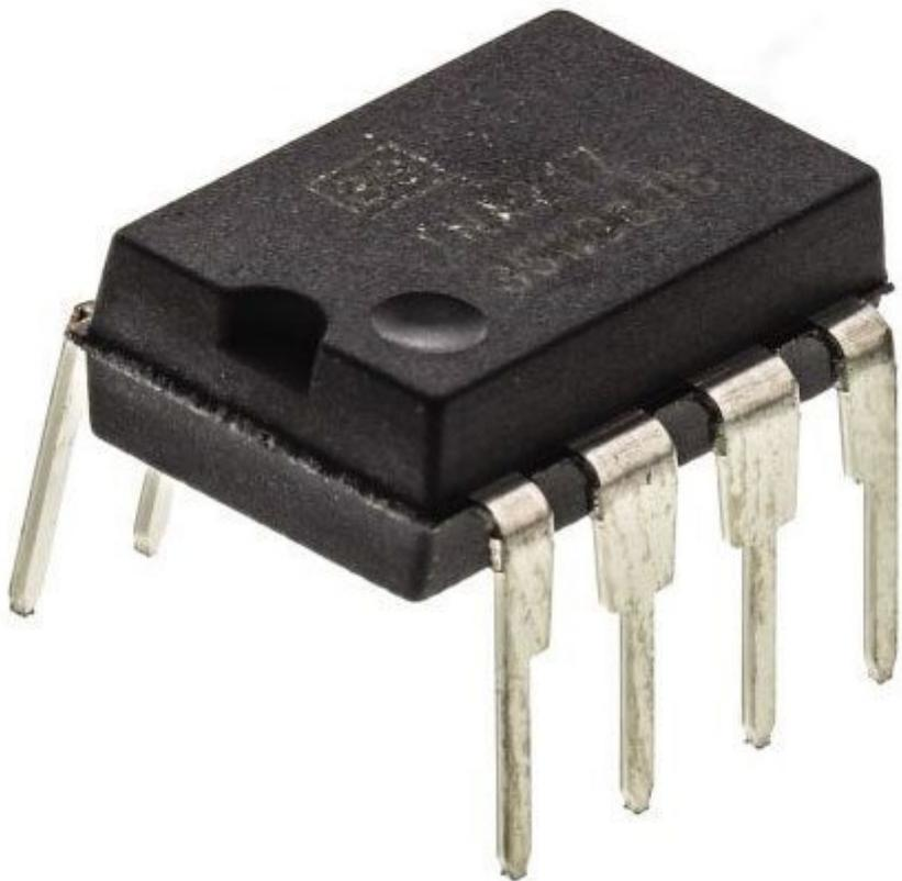
INA217AIP è un circuito integrato con funzione di amplificatore per strumentazione, case PDIP8 pin.
