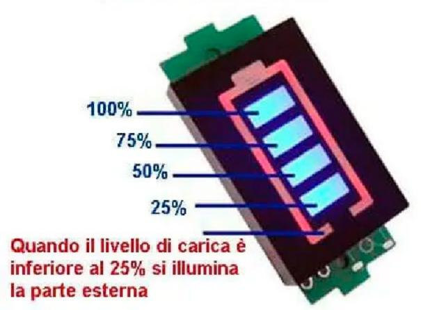
Voltmetro in miniatura (43,5x20 mm) in grado di visualizzare, tramite 4 LED blu, la percentuale di carica di una batteria al litio da 3 celle. Dimensioni (mm): 43,5x20x9.
