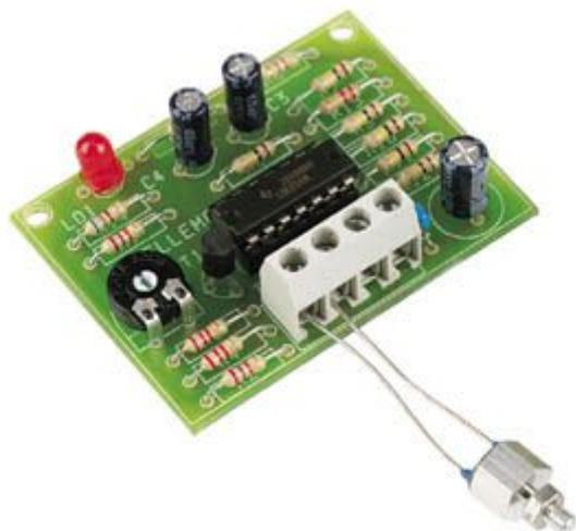
Guidate con maggiore sicurezza nella stagione fredda. Questo circuito fa uso di un LED lampeggiante per indicare che la temperatura della strada è prossima alla formazione di ghiaccio ; al di sotto di quel punto il LED permane costantemente acceso. E' incluso nel kit un affidabile sensore di temperatura completo di collare per il montaggio.
