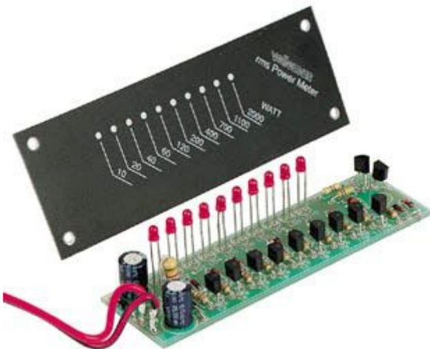
Dotato di scala a 10 LED, è in grado di misurare potenze sino a 400 W (rms) su 4 ohm. Non necessita di alcun alimentatore speciale, poiché l'alimentazione viene fornita direttamente dal segnale in altoparlante. Ideale per impianti audio in auto e sistemi PA. Idoneo anche all'impiego in amplificatori con configurazione a ponte. Può essere utilizzato in posizione orizzontale o verticale. Il dispositivo viene fornito già montato.
