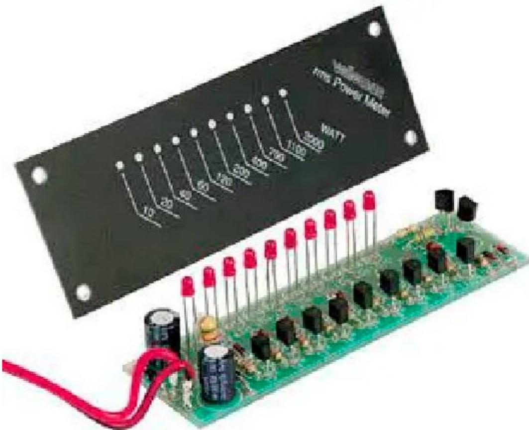
Dotato di scala a 10 LED, è in grado di misurare potenze sino a 1000 W (rms) su 8 ohm. Non necessita di alcun alimentatore speciale, poiché l'alimentazione viene fornita direttamente dal segnale in altoparlante. Ideale per impianti audio in auto e sistemi PA. Idoneo anche all'impiego in amplificatori con configurazione a ponte. Può essere utilizzato in posizione orizzontale o verticale. Il dispositivo viene fornito già montato.
