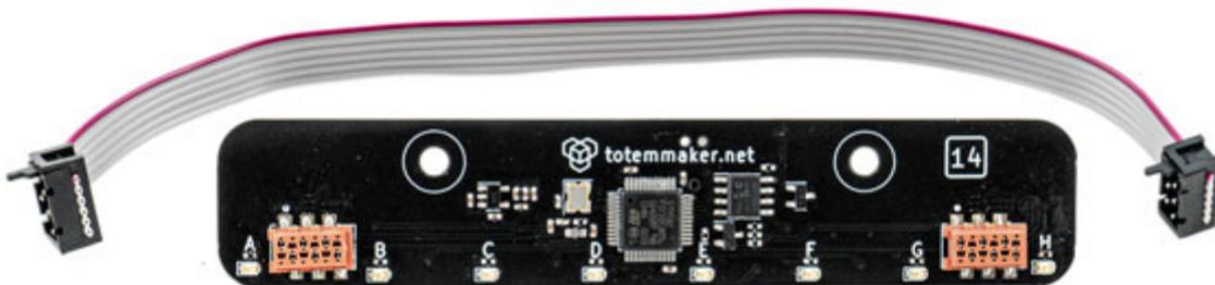
Inseguitore di linee per Totem RoboBoard X4 (non compreso). Questo sensore esegue tutti i calcoli richiesti e restituisce i dati elaborati senza la necessità di alcun codice o librerie aggiuntive. Il calcolo interno fornisce anche funzionalità come il contrasto automatico e il rilevamento del colore delle linee. Non è necessario calibrare questo sensore per ogni superficie o impostare il colore della linea. Lo fa automaticamente.
