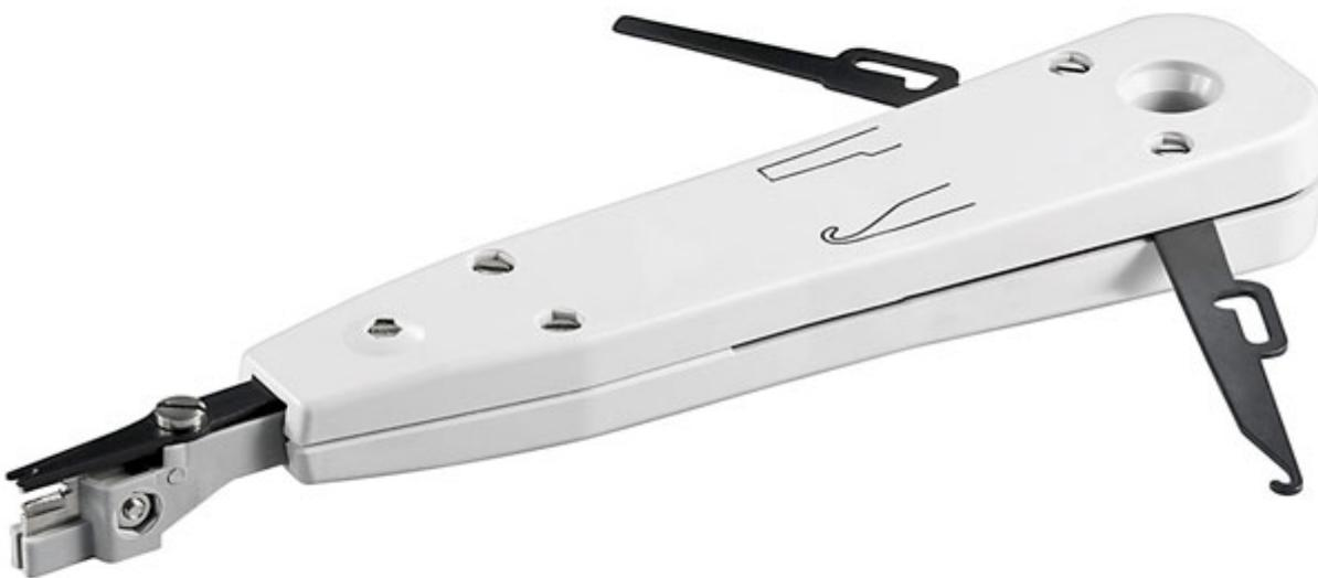
Pratico ed economico inseritore a pressione per inserire cavi di rete CAT 5 su moduli di collegamento LSA. Dotato di lama intercambiabile con vite di bloccaggio, uncino e separatore incorporati, impugnatura ergonomica. Può essere utilizzato per conduttori con un diametro da 0,4 mm a 0,6 mm, inserimento e taglio dei cavi in un'unica operazione. Dimensioni (mm): 176x37x21.
