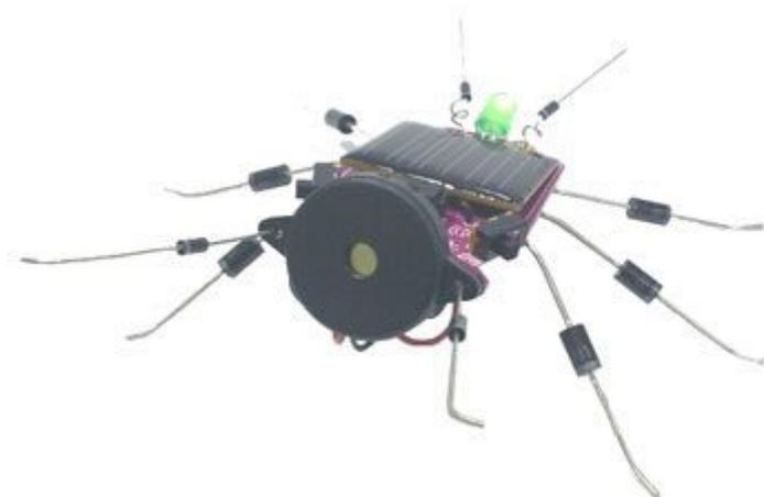
Originale insetto elettronico che frinisce o si illumina fino a quando il sole splende grazie al micro pannello fotovoltaico (4,5 V / 35 mA) di cui dispone. Con l'utilizzo di due batterie ricaricabili 2x AAA NiMH o NiCd (opzionali), l'insetto si ricarica durante il giorno e frinisce o si illumina di notte simulando una cicala o una lucciola. Dimensioni: 140 (Lung.) x 150 (Larg.) x 5 (Alt.) cm. Per il funzionamento è necessaria l'esposizione alla luce solare.
