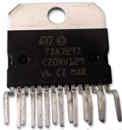
Il TDA7297 è un chip amplificatore audio in classe AB, con potenza di uscita di 2x15 watt, impedenza di carico 8 ohm, alimentazione da 6,5 a 18 volt e case Multiwatt a 15 pin.
