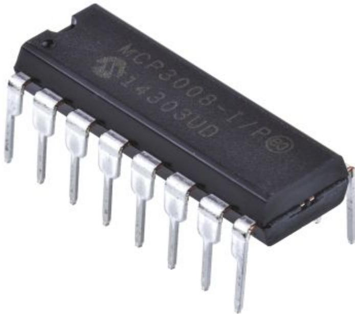
L'MCP3008 della Microchip è un integrato convertitore Analogico/Digitale (ADC) a 10 bit caratterizzato da elevate prestazioni e basso consumo che lo rendono l'ideale per la realizzazioni di applicazioni di controllo. Interfaccia: SPI. Tensione di alimentazione compresa tra 2,7V e 5,5V, corrente massima 500 $\mu$ A, temperatura di lavoro: da -40°C a +85°C.
