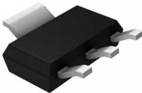
L'integrato LT3092EST è un generatore di corrente costante programmabile della Linear Technology. Può essere alimentato con una tensione compresa tra 1,2 V e 40 V, ed è in grado di erogare una corrente di valore compreso tra 0,5 e 200 mA, con un'accuratezza iniziale dell'1%; il rapporto tra R2 e R3 determina il valore della corrente erogata, secondo la seguente relazione:  $I = 10\mu A(R2/R3)$ . Case: 3 pin TSOT-23.
