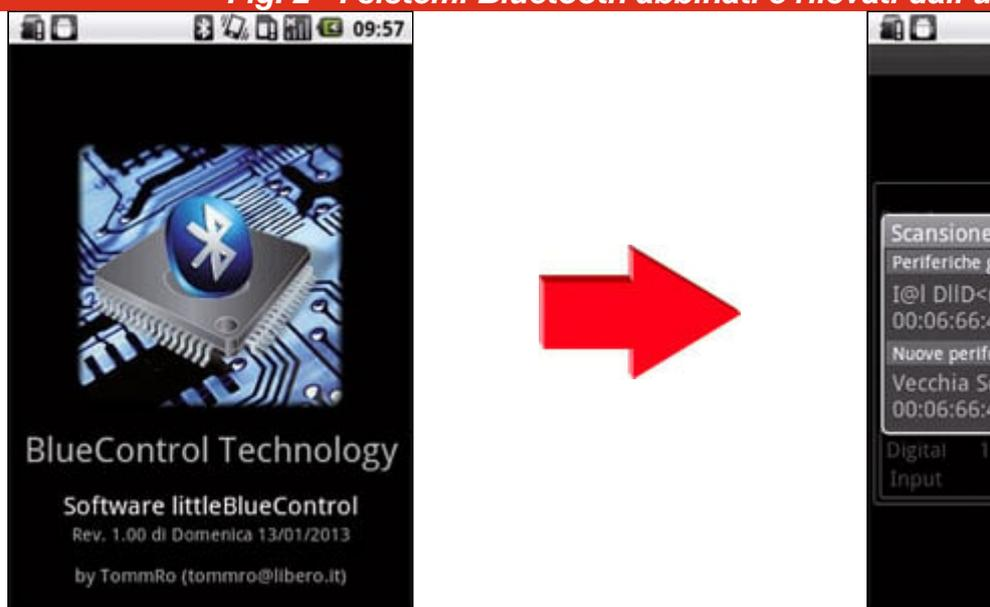
Nella lista visualizzata a destra in Fig. 2, vengono mostrati sia tutti i sistemi già accoppiati, sia i nuovi rilevati (nel nostro esempio) la si seleziona e si richiede l'avvio del collegamento. A questo punto, se è la prima digitazione del PIN code (quello predefinito dal firmware è 1234) come mostra la Fig.3.
