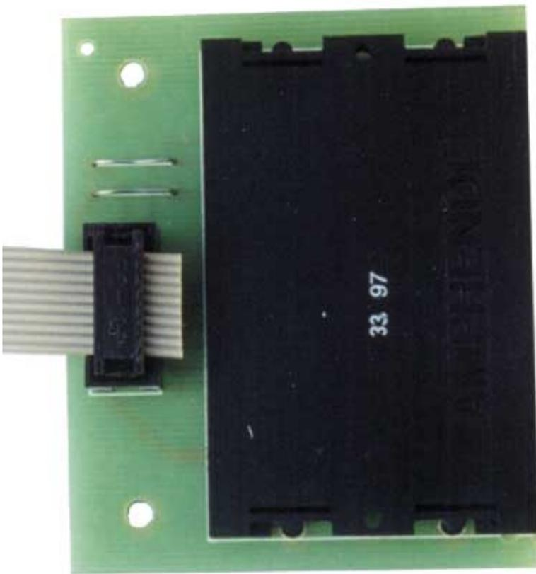
Scheda di interfaccia con il connettore ISO per Smart Card.
