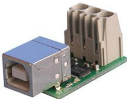
Interfaccia USB-RS485 in grado di funzionare con baud rate fino a 250 kbps (bits). Il modulo preleva l'alimentazione direttamente dalla porta USB del PC e comunica con questo tramite una porta seriale virtuale che viene creata quando viene connesso alla porta USB. Tutti i dati inviati alla porta seriale virtuale vengono automaticamente convertiti in RS485 e viceversa. Possibilità di collegare fino a 128 dispositivi sullo stesso bus.
