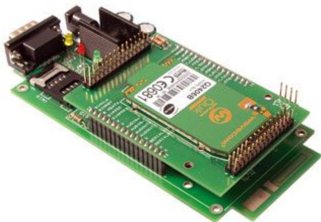
Interfaccia per stazioni meteo comandabile via SMS che, a richiesta o automaticamente, invia i dati meteo in formato testo compresso o esteso, mediante SMS o su server Internet usando un FTP su rete GPRS. Il file pubblicato può essere consultato in qualsiasi momento, ovunque sia disponibile una connessione Internet.
