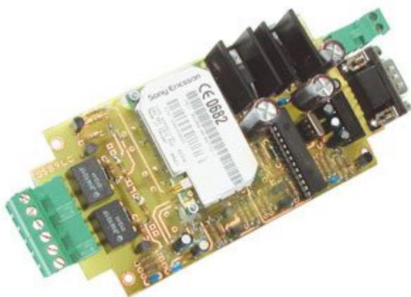
Interfaccia GSM per Stazioni Meteorologiche tipo WS2300, WS2305, ecc. Ogni volta che riceve una chiamata da un cellulare risponde con un SMS comunicando i dati meteorologici rilevati sul posto. Permette anche di gestire utilizzatori a distanza, mediante due uscite provviste di relé. Il kit comprende tutti i componenti, il contenitore, le minuterie e l'antenna GSM piatta.
