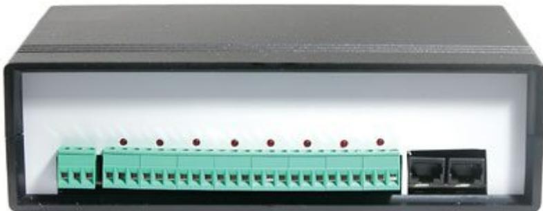
Scheda d'interfaccia per PC prevista per essere collegata alla porta USB. Consente di controllare otto uscite a relè e di leggere otto ingressi digitali e due analogici. Un software di gestione appositamente realizzato consente di attivare le uscite e visualizzare lo stato degli ingressi. Non comprende il contenitore nè l'alimentatore.
