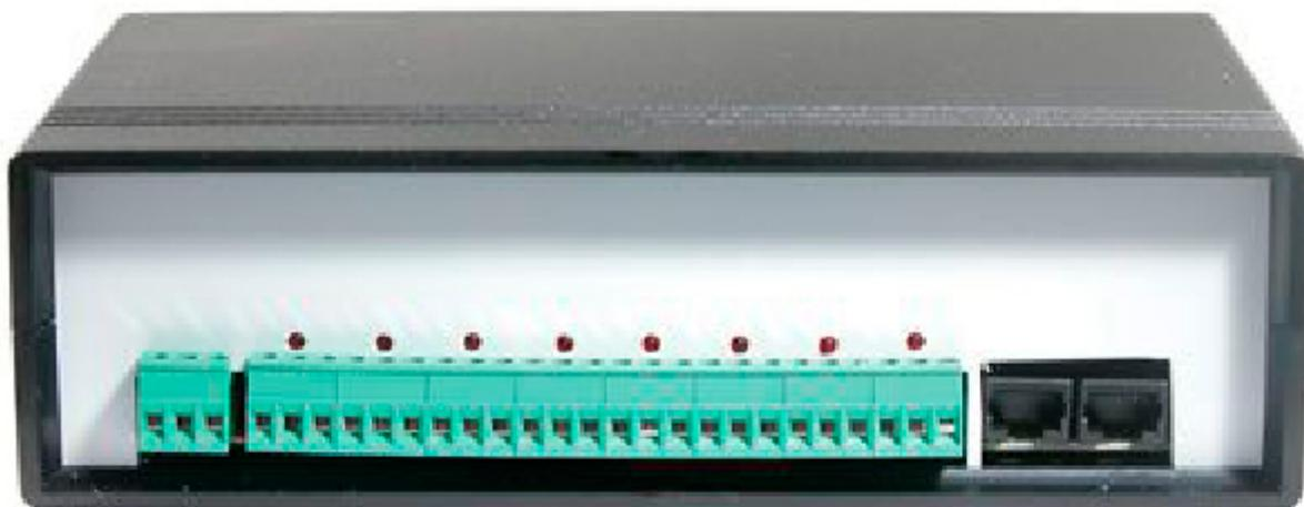
Scheda d'interfaccia per PC da collegare alla porta seriale. Consente di controllare otto uscite a relè e di leggere otto ingressi digitali e due analogici. Un software di gestione appositamente realizzato consente di attivare le uscite e visualizzare lo stato degli ingressi. Viene fornito col software per PC. Il kit non comprende l'alimentatore né il contenitore.
