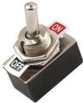
Interruttore di potenza in grado di attivare carichi con assorbimento massimo di 2 A a 250 V o 4 A a 125 V. Tipo: SPST (ON)-(OFF). Include una piastra anteriore e due dadi filettati per il montaggio. Può essere utilizzato con il prodotto 7300-INTPROT. Dimensioni 12,7 x 13,9 x 36,8 mm. Terminali a saldare.
