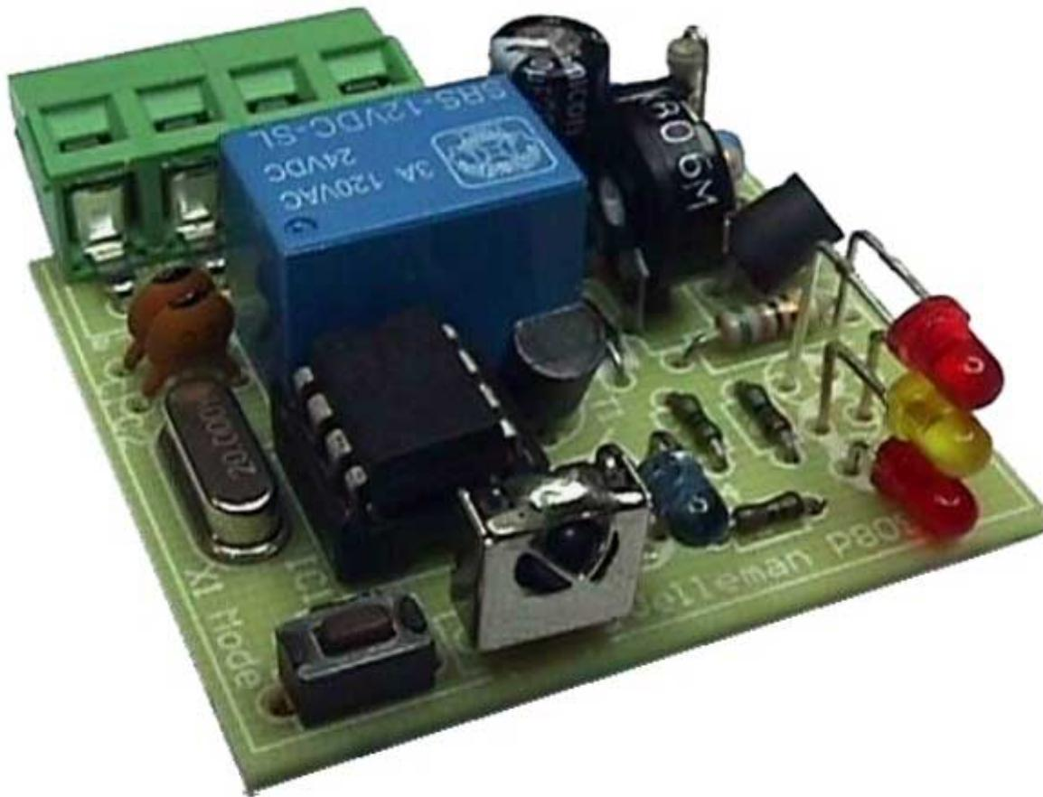
Sensore ottico di prossimità che, al semplice passaggio della mano (senza contatto), permette l'attivazione di un relè. Particolarmente indicato per sistemi Velbus, apertura automatica di cancelli, porte, accensione luci, ecc. Sensibilità regolabile, indicazione di stato a LED. Tecnologia infrarossa. Non adatto per rilevare oggetti molto scuri. Fornito con contenitore snap-in per placchette Velbus codice 8220-VMBFLG e 8220-VMBFDG.
