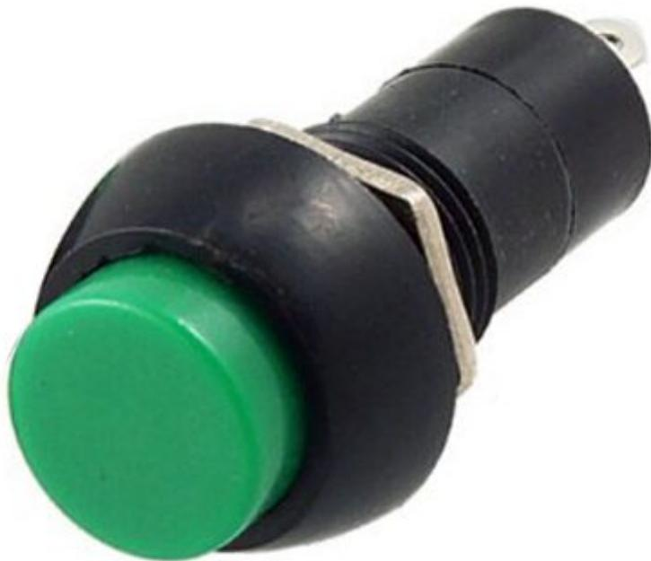
Interruttore a pulsante 3 A - 125 VAC / 1 A 250 VAC, resistenza isolamento >500 VDC 100 Mohm, resistenza contatto < 20 Mohm, vita media: >50.000 cicli on/off. Dimensioni max. (mm): 39,1x18, diametro foro di fissaggio: 12 mm, terminali a saldare.
