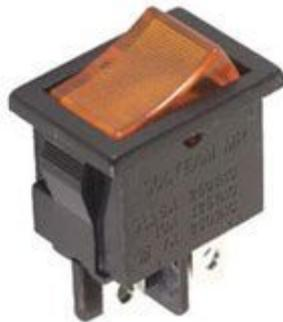
Interruttore con luce al neon ambra. Specifiche tecniche: tipo: on/off DPST (doppio interruttore), portata contatti: 5 A / 250 Vac, 10 A / 125 Vac, vita meccanica media: 50000, cicli (on-off), resistenza dei contatti: < 20Ohm, resistenza di isolamento: 1000MOhm, resistenza dielettrico: >1500V: 1 minuto - >3000V: tra i poli, temperatura di lavoro: -30
