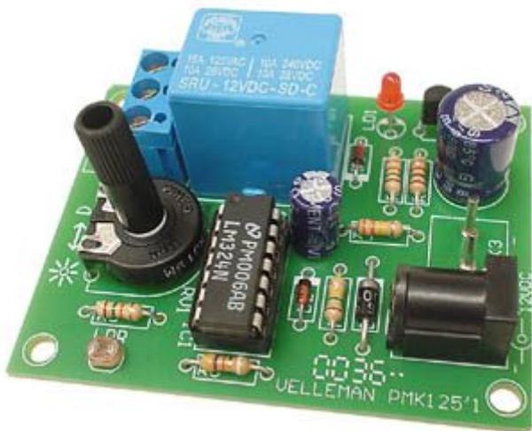
Semplice circuito in grado di accendere automaticamente una o più lampade o di alimentare un qualsiasi dispositivo elettrico all'insorgere del buio. L'interruttore tornerà alla condizione iniziale non appena il livello di luminosità raggiungerà quello preimpostato. Sensibilità del dispositivo regolabile mediante trimmer.
