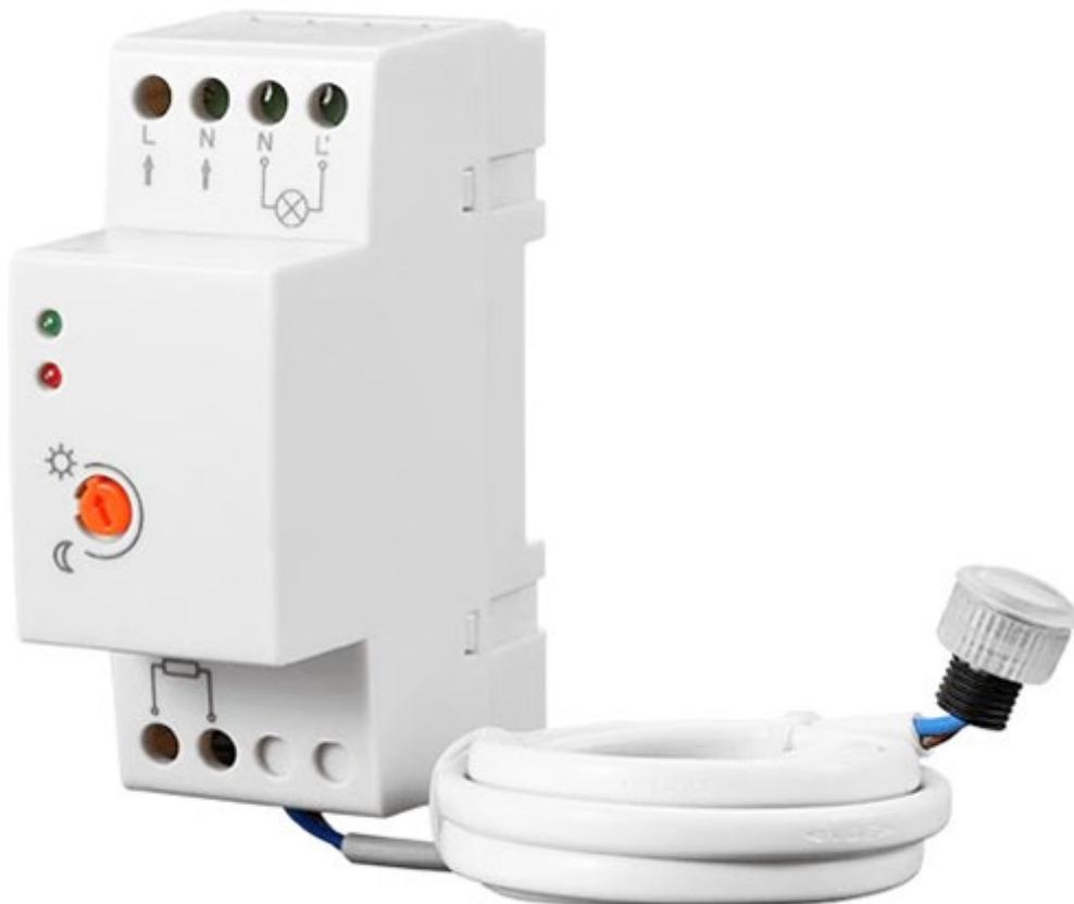
Interruttore crepuscolare per montaggio su guida DIN. Dispone di sensore esterno, collegabile tramite cavo, con grado di protezione IP65. Consente l'attivazione di un dispositivo, funzionante a 220 Vac, al sopraggiungere della sera e alla loro disattivazione quando rileva la luce del giorno.
