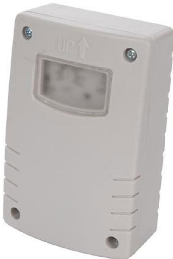
Originale interruttore crepuscolare con timer. Permette di accendere automaticamente, per un tempo regolabile da 1 a 9 ore (regolabile) e in base alla luce ambiente, lampade fino a 1200 watt. Alimentazione: 220-240 VAC 50 Hz, grado di protezione: IP44.
