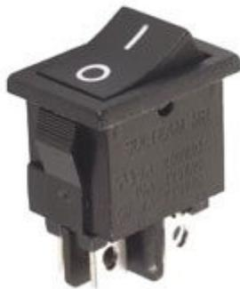
Interruttore tipo on/off DPST (doppio interruttore), portata contatti: 5 A / 250 Vac, 10 A / 125 Vac, vita meccanica media: 50000, cicli (on-off), resistenza dei contatti: < 200hm, resistenza di isolamento: 1000 MOhm, resistenza dielettrico: >1500 V: 1 minuto - >3000 V: tra i poli, temperatura di lavoro: -30
