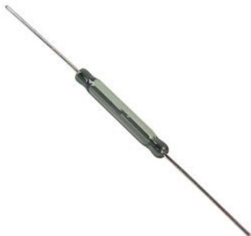
Interruttore reed miniatura dotato di 1 contatto normalmente aperto (in assenza di magnete) in grado di operare con corrente massima di 0,5 A. Viene attivato da un campo magnetico.
