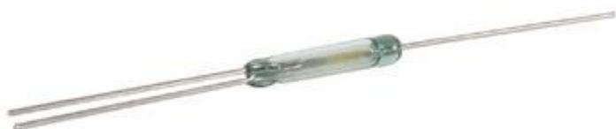
Interruttore reed miniatura dotato di 1 contatto normalmente chiuso e 1 normalmente aperto in grado di operare con corrente massima di 0,25A. Viene attivato da un campo magnetico.
