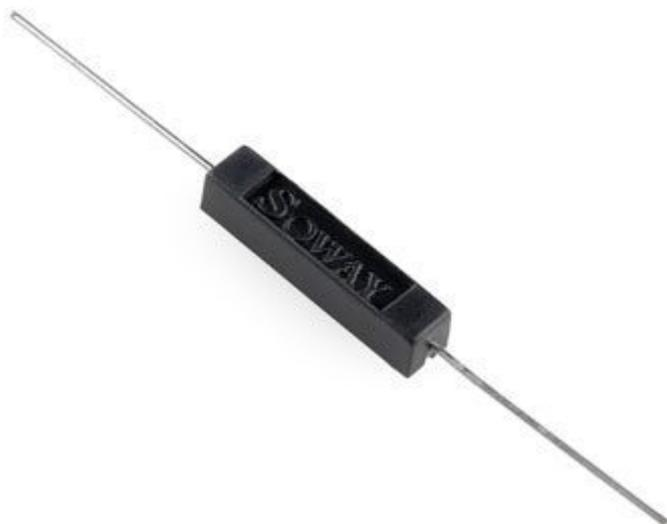
Interruttore reed miniatura dotato di 1 contatto normalmente aperto (in assenza di magnete) in grado di operare con corrente massima di 1 A. Viene attivato da un campo magnetico.
