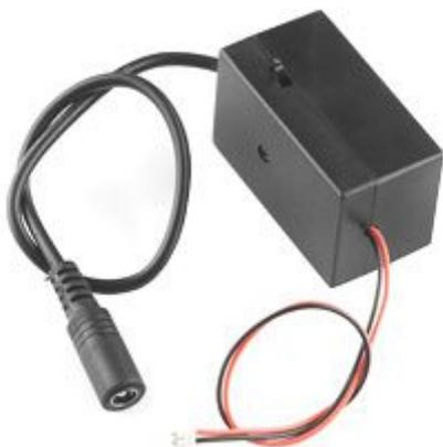
Inverter adatto per pilotare i cavi elettroluminescenti con una tensione continua di 12 V. Il cavo di uscita termina con un connettore JST. Dispone di interruttore ON/OFF e funzionamento lampeggiante. Dimensioni: 54 x 34 x 29 mm.
