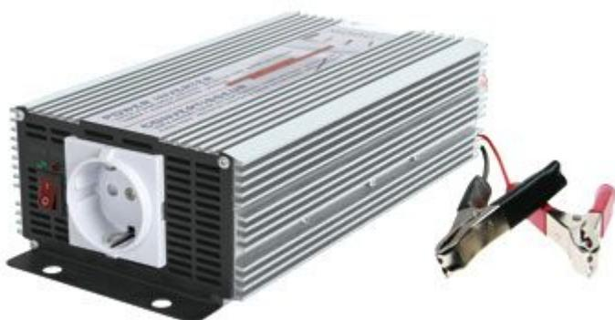
Inverter DC/AC con tensione d'ingresso 12 Vdc e tensione d'uscita di 230 Vac con presa schuko. Il dispositivo è dotato, oltre che di funzione Soft-Start, anche di funzione Auto-Restart (con fusibile autoripristinante) che, in caso di sovraccarico momentaneo, inibisce il funzionamento dell'inverter per circa 10 secondi. Ideale per alimentare con la batteria del proprio veicolo TV, VCR, impianti HI-FI, frigoriferi, ecc...
