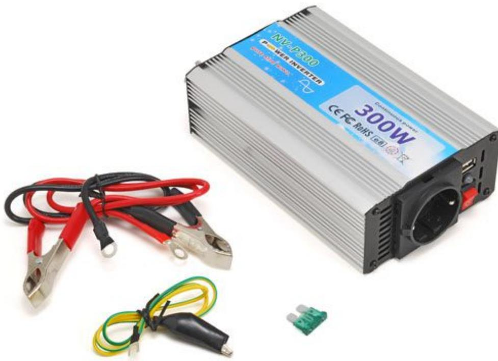
Inverter da 12 Vdc a 220 Vac con forma d'onda d'uscita sinusoidale pura e potenza massima di 300 Watt. L'inverter è dotato di protezione da sovraccarico, sovratensione d'ingresso, cortocircuito e allarme batteria scarica. Dispone di uscita USB (5 V – 500 mA), presa di tipo Schuko e può essere utilizzato per alimentare: TV, VCR, PC, impianti HI-FI, frigoriferi, ecc. La confezione comprende anche i cavi per il collegamento alla batteria.
