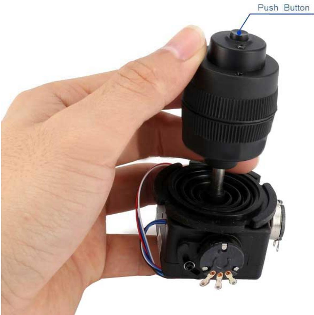
Joystick con potenziometro con ritorno a molla nell'impugnatura, pulsante sulla parte superiore e due potenziometri per i movimenti direzionali (su, giù, destra e sinistra), uno per ciascun asse. Dimensioni: altezza totale 95 mm, altezza impugnatura 43 mm, base 40,4x40,4 mm. Particolarmente indicato per essere utilizzato in applicazioni come controller per Robot, CNC, controllo CCTV, ecc.
