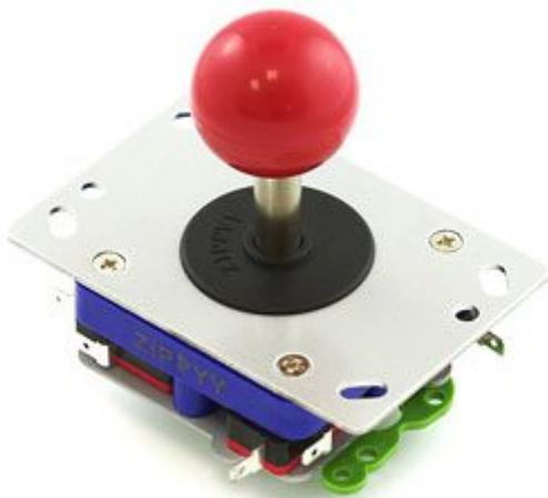
Robusto Joystick con impugnatura corta, molto simile a quello utilizzato nei videogiochi arcade come il PACMAN. I movimenti direzionali (su, giù, destra e sinistra) sono ottenuti tramite microswitch, uno per ciascun asse. Dimensioni: altezza totale 101 mm, altezza impugnatura 60 mm, base 97 x 65 mm. Particolarmente indicato per la realizzazione di controller per Robot, CNC, ecc.
