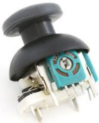
Piccolo joystick da c.s. molto simile a quello utilizzato nel controller della PS2 (PlayStation 2). I movimenti direzionali (su, giù, destra e sinistra) sono ottenuti dalla variazione resistiva, effettuata tramite due potenziometri da 10 kohm, uno per ciascun asse. Dispone inoltre di un pulsante che si attiva quando il joystick viene premuto verso il basso. Particolarmente indicato per la realizzazione di controller per Robot. Dimensioni: 21 x 25,87 x 30,54 mm.
