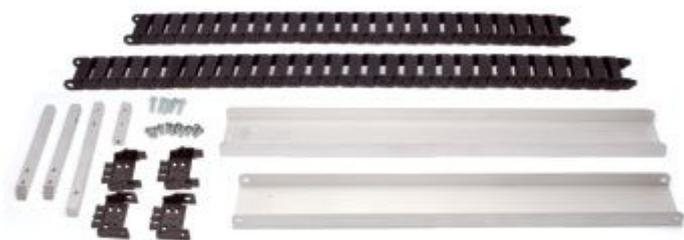
Permette la corretta installazione dei cavi di alimentazione/controllo sulla meccanica CNC (7300-CNC3025). Comprende la catena per l'asse X e quella per l'asse Y, le canaline, i supporti ed il necessario per il fissaggio.
