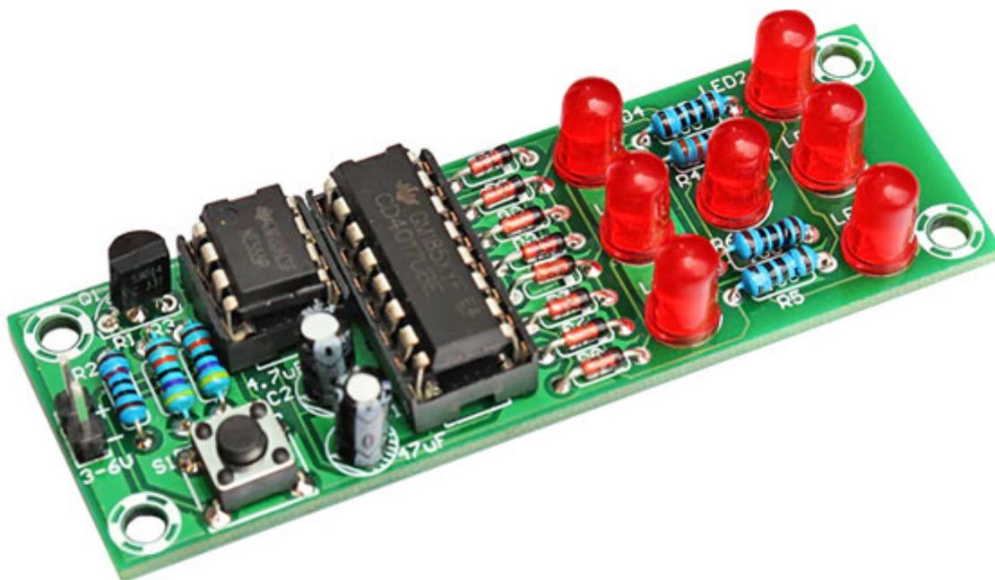
Semplice circuito in kit che permette di realizzare un dado elettronico. Basta premere il pulsante e il numero del dado verrà visualizzato, in modo casuale, con l'accensione dei LED. Alimentazione: da 3 a 6 Vdc.
