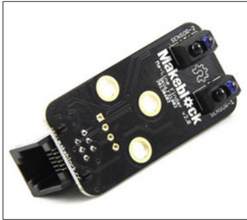
Il modulo *Me-Line Finder* è stato progettato per l'inseguimento di una linea nera su uno sfondo bianco o viceversa. Dispone di due sensori, ognuno dei quali è formato da un LED IR che emette ed un fototransistor sensibile all'infrarosso che riceve
