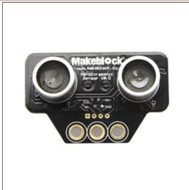
Il modulo Me Ultrasonic Sensor può essere utilizzato per misurare la distanza o evitare ostacoli da 3 cm a 4 m
