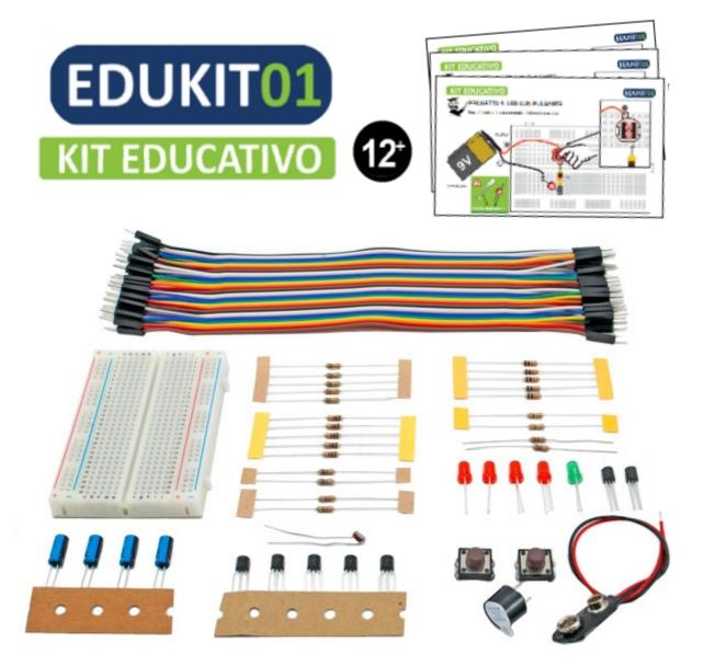
Confezione contenente una breadboard 400 contatti con base autoadesiva e una serie di componenti per realizzare 11 progetti di elettronica di base. Divertente, sicuro ed educativo, non richiede alcuna saldatura. Tra i progetti: LED lampeggianti, sensore di luce, tester di polarità, circuito di start-stop, timer e altri.
