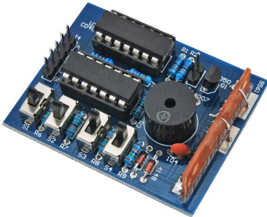
Consente di generare 16 differenti suoni controllabili manualmente tramite 4 selettori, oppure esternamente tramite codifica. Alimentazione 3Vdc, dimensioni 48x42mm. Istruzioni per il montaggio in italiano.
