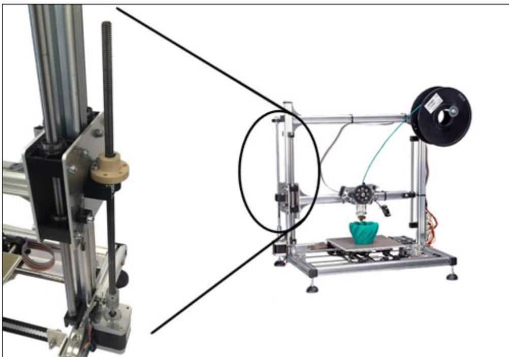
Questo set è composto da una barra filettata trapezoidale, una madrevite e un giunto flessibile per accoppiamento albero motore e barra filettata. Sostituendo questo set con quello fornito in dotazione alla stampante 3DRAG, permette di migliorare la precisione dell'asse Z e migliorare la finitura superficiale dell'oggetto. **Attenzione!** per utilizzare questo set è necessario aggiornare il firmware della scheda.
