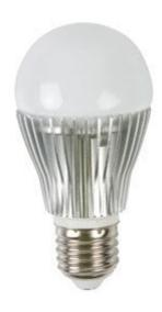
Lampada dotata di 4 LED a luce bianco caldo. Alimentazione 230 Vac, flusso luminoso: 235 lumen, angolo di diffusione: 240°, attacco E27.
